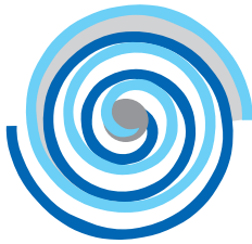
涡旋压缩机的压力是由于作行星运动的涡旋盘之间的相互作用产生的。当涡旋盘之一作行星运动时气体从外开口进入。
