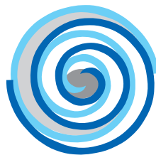
气体进入涡旋盘后,开口封闭
