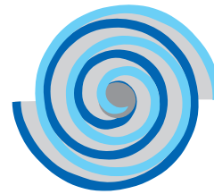
事实上,在运作中,所有6个气体通道均处于不同的压缩阶段,从而保证吸气和排气过程基本连续而不间断。
