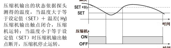
注: 一旦温度探头失灵 (未可靠连接或损坏) 压缩机按照参数 "Cy" 和 "Cn" 所设定的运转时间和停止时间以固定开停比的方式来运行。
