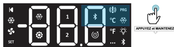
Déverrouillage de l'affichage du boîtier CC200
