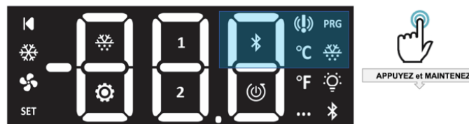
Déverrouillage de l'affichage du boîtier CC200
