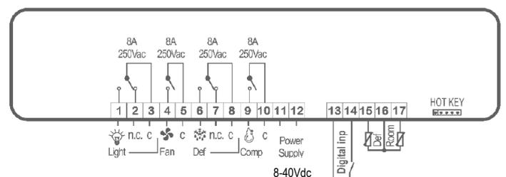
图中英文说明: Room Probe/ Room: 库温探头; Def/Def. Probe/Evap. Probe: 蒸发器探头; Digital Input: 可设置数字输入; HOT KEY: 编程钥匙接口; Light: 库灯; Comp: 压缩机; Fan: 风扇; Def: 融霜; n.c.: 常闭触点; c: 公共端; Power Supply: 电源; Neutral: 零线; Line: 火线; MAX20A: 最大瞬时电流 20A。
