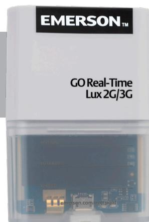
GO Real-Time Lux 2G/3G Trackerを使用すると、輸送中の貨物を簡単に追跡することができます。国境、DOT検問所、荷受け埠頭など貨物のある場所に関係なく、誰かが貨物にアクセスした時間と場所をリアルタイムで知ることができます。もちろん、輸送中の製品の温度も確認することができます。これからデュアルモード2G/3Gセルラー技術によりデータの接続性及びアクセス性がさらに向上します。セルラー技術によって貨物輸送中にも温度及び位置データの可視性を確保することができます。
