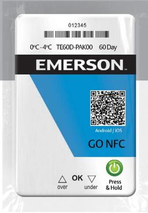
GO NFC Loggerは、流通経路（輸送及び保管中）において腐敗しやすい製品の時間と温度をモニタリングします。ロガーは薄くてフラットな形状で、スマートフォンやタブレットなどを使用し、近距離通信(NFC)を介して時間・温度データを転送・閲覧できます。データは、モバイルアプリや専用のPad Readerを介して機器の画面にすぐ表示されます。また、GO NFC LoggerはAndroid及びiOSのスマートフォンの機能を活用するため、専用リーダーソフトを必要としません。データは、モバイルアプリを介して電子メールで簡単に転送することができます。
