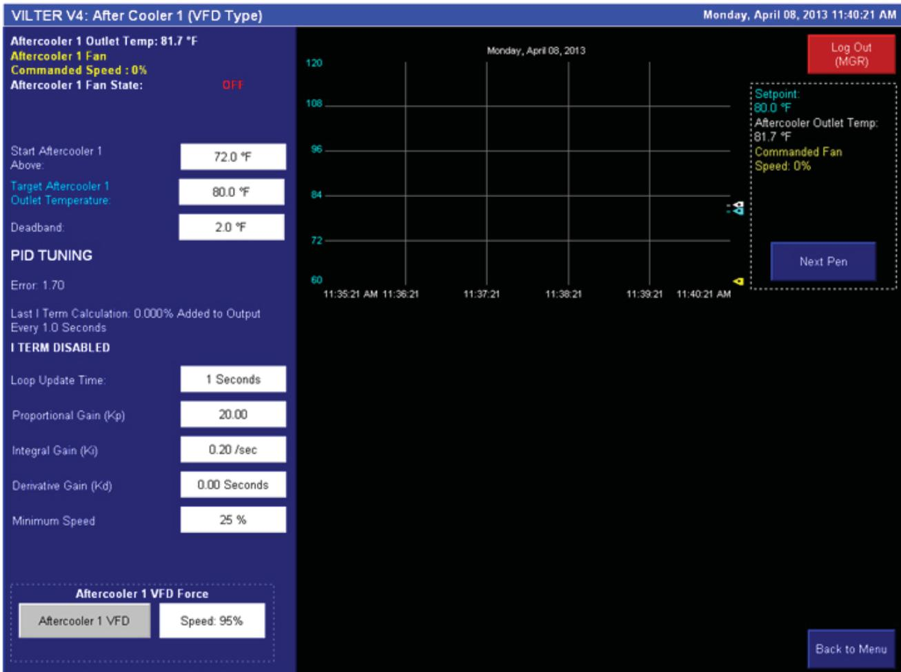
Figure 9-4. Aftercooler (VFD Type) Screen
