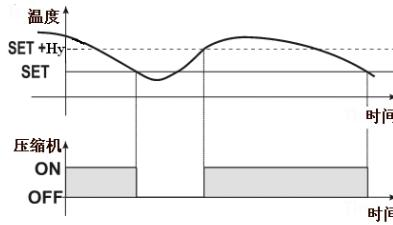
注：一旦温度探头失灵（未可靠连接或损坏）压缩机按照参数 “Cy” 和 “Cn” 所设定的运转时间和停止时间以固定开停比的方式来运行。
