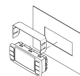
CX40 键盘应该安装在垂直的面板上，开孔尺寸为 29x71 mm，并用专用的塑料卡子将其固定。
