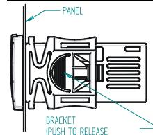
XR30CX 温控器应该固定在竖直的面板上, 面板上开孔尺寸 29x71 mm, 并用专用的塑料卡子将其固定。
