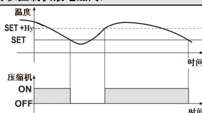
注：一旦温度探头失灵（未可靠连接或损坏）压缩机按照参数 “COn” 和 “COF” 所设定的运转时间和停止时间以固定开停比的方式运行。
