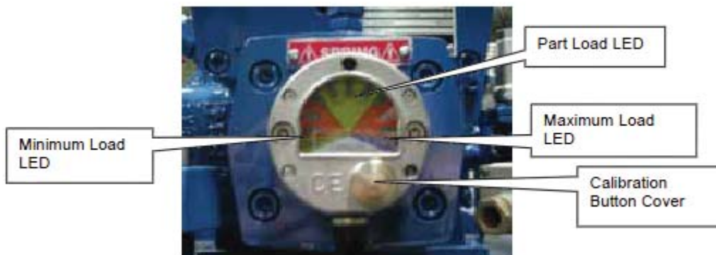
Figure 6-8. Linear Position Indicator (LPI)
