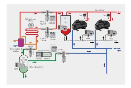
Le mode de dérivation à moyenne pression du fluide est utilisé pour réduire la quantité de gaz dans le réservoir moyenne pression après la vanne du refroidisseur de gaz. Il régule le fluide frigorigène liquide jusqu''à un niveau basse pression avant la vanne de détente au niveau des évaporateurs. La pression de service maximale peut atteindre 90 bar.
