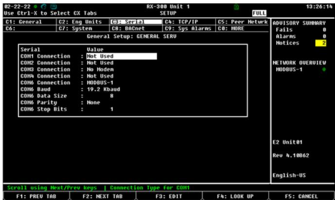
3. Cet écran aura un champ de connexion pour tous les ports COM disponibles sur le E2E. Mettez en évidence la connexion du port COM que vous utiliserez pour Modbus et appuyez sur **F4** :RECHERCHER et sélectionnez Modbus -1 dans la liste des types de réseau.
