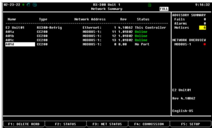
3. Mettez en évidence le premier appareil à adresser et appuyez sur **F4**: **MISE EN SERVICE**. Un écran apparaîtra avec une liste d'adresses Modbus. Si un nom de contrôleur a déjà été attribué à une adresse Modbus, le nom apparaîtra à côté de la gauche du numéro d'adresse Modbus.
