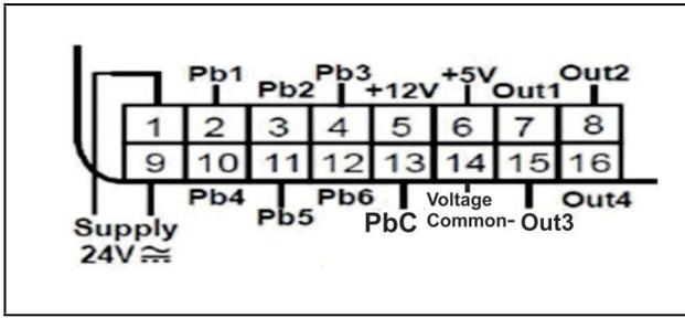
Figure 4-2 - Analog Inputs
